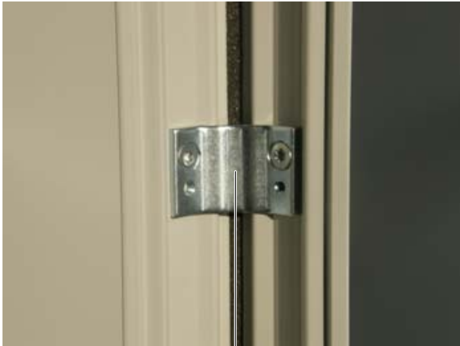
Наружная шкафная стяжка Момент затяжки: 9 Нм
